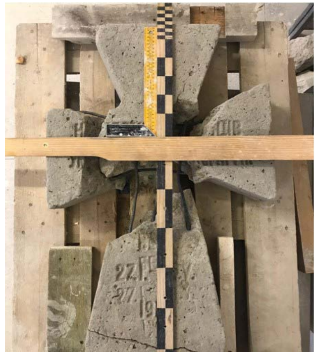
Іл. 6. Вирівнювання деформації об'єкта відносно площини та осі. Процес визначення осі симетрії. 2018. [Світлина автора]
