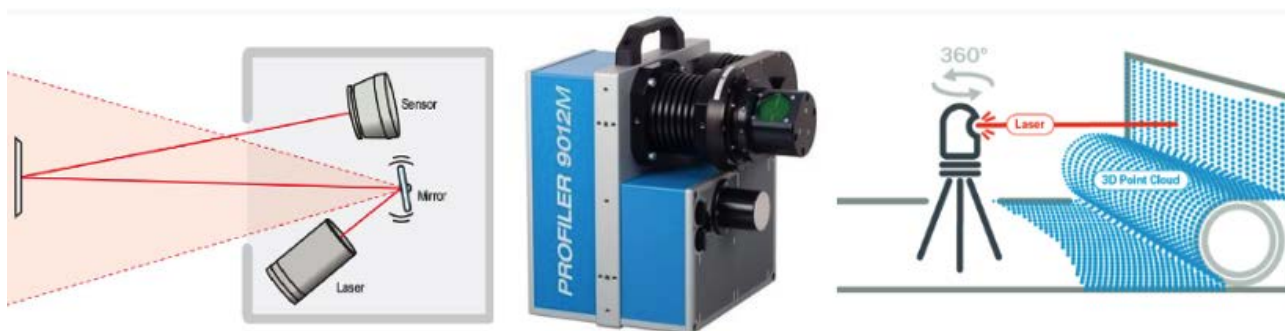
Іл. 1. Лазерний сканер вимірює відстань до об'єкта за часом прольоту лазерного променя та аналізує відбитий сигнал для визначення властивостей поверхні. [16]
